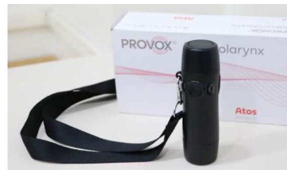
Modelos atuais de laringe eletrônica são portáteis e funcionam com baterias recarregáveis
